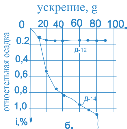
Рис. 2. Исследование модели откоса канала а – схема модели; б – график осадки
