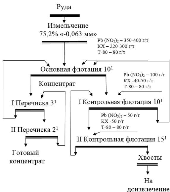
Рисунок 1. Рекомендуемая схема флотации руды нижних горизонтов Дзижикрутского месторождения
