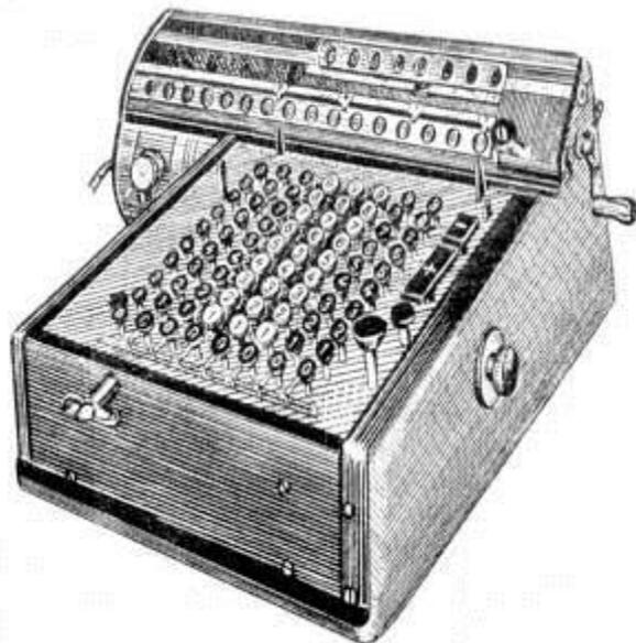
**В 1935 г. в СССР был выпущен клавишный полуавтоматический арифмометр КСМ-1 (клавишная счетная машина). Эта машина имела два привода: электрический (со скоростью 300 оборотов в минуту) и ручной (на случай отсутствия питания).**
