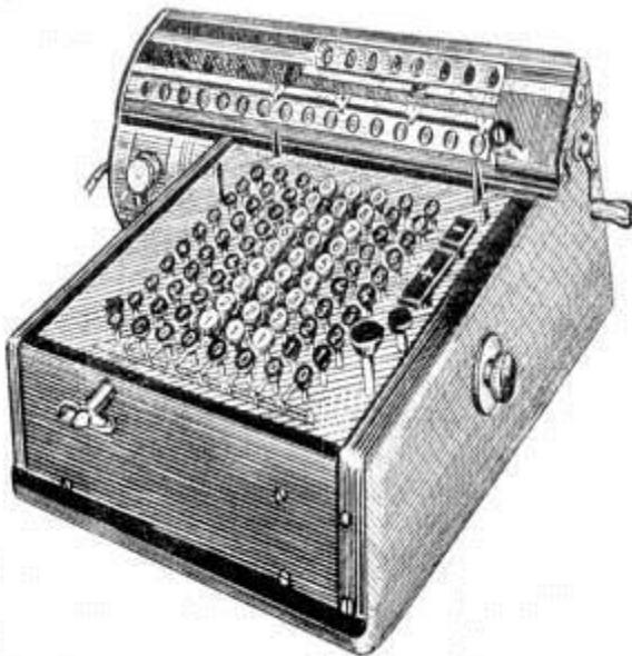
**В 1935 г. в СССР был выпущен клавишиный полуавтоматический арифмометр КСМ-1 (клавишиная счетная машина). Эта машина имела два привода: электрический (со скоростью 300 оборотов в минуту) и ручной (на случай отсутствия питания).**
