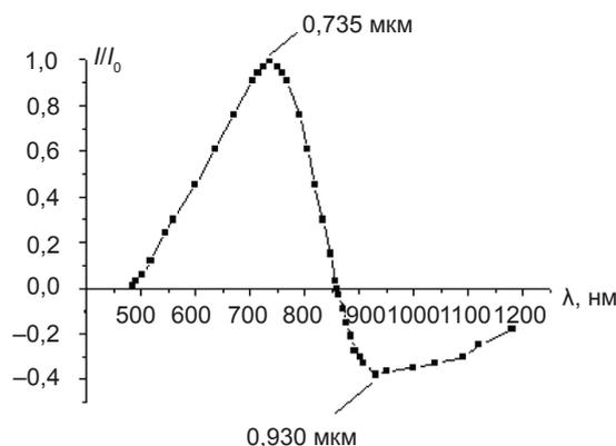
Рис. 2. Спектральное распределение  $n^+CdS-nCdS-nSi$ -структуры
