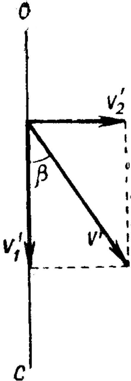
Nisbiy tezlikni radius bo'yicha yo'nalgan  $V_1$ , tashkil etuvchiga va radiusga tik  $V_2$  tashkil etuvchiga ajratish
