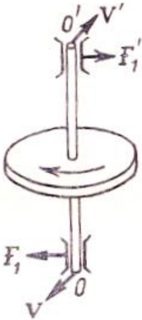
Giroskop o'qini ushlab turuvchi bog'lanishlarga ta'sir qilayotgan giroskopik  $F_1$  va  $F'_1$  kuchlar.
