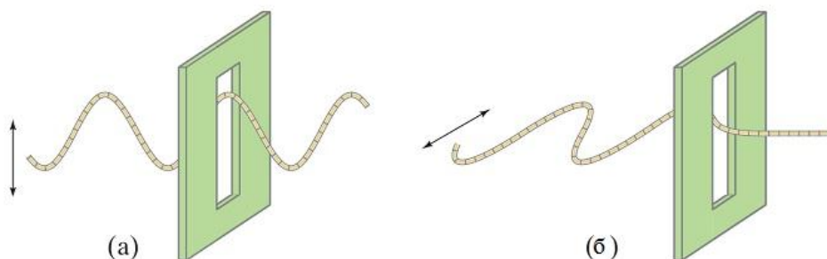
24-39 Расм (а) вертикал поляризацияланган тўлқин вертикал тирқишдан ўтмоқда, лекин (б) горизонтал поляризациялангани эса йўқ.
