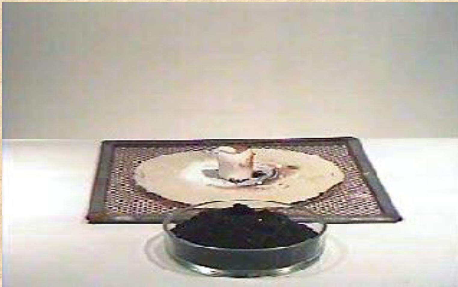
Разгорание тлеющей лучины свидетельствует от том, что происходит выделение кислорода:  $2\text{KMnO}_4 \rightarrow \text{K}_2\text{MnO}_4 + \text{MnO}_2 + \underline{\text{O}_2}\uparrow$
