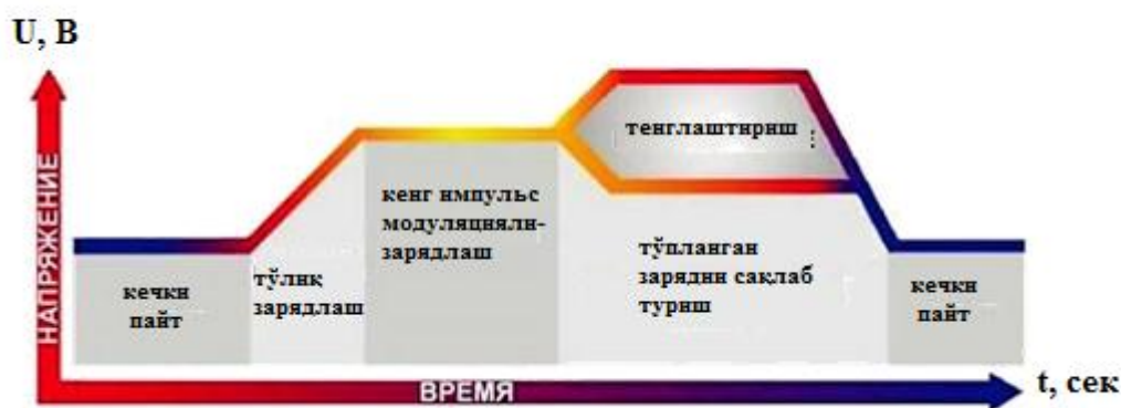
5-Rasm. Quyosh panelidan akkumulyatorni zaryadlashdagi bosqichlar
