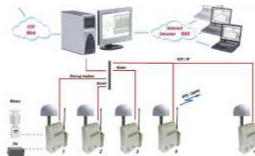
4-расм. Базавий станция йўлдош геодезияси приёмниги жиҳозлари ва йўлдош геодезияси приёмниги
