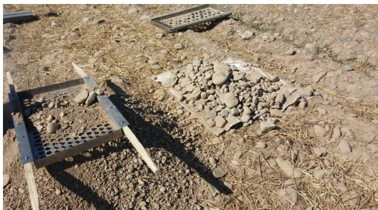
**5-расм. Тўрт хил фракцияларга (ўртача диаметри 0,03-0,3 м), ўртача тошли (ўртача диаметри 0,3-0,6 м), йирик тошли (ўртача диаметри 0,6- 1,0 м), ўта йирик тошли (ўртача диаметри 1,0 м дан катта) ажратиш жараёни.**
