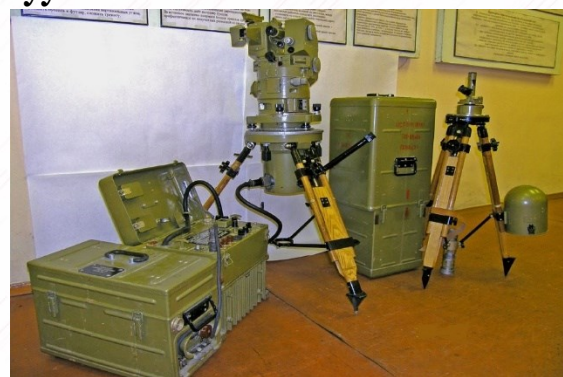
4-rasm. 1Г17 markadagi girokompas uskunasi
