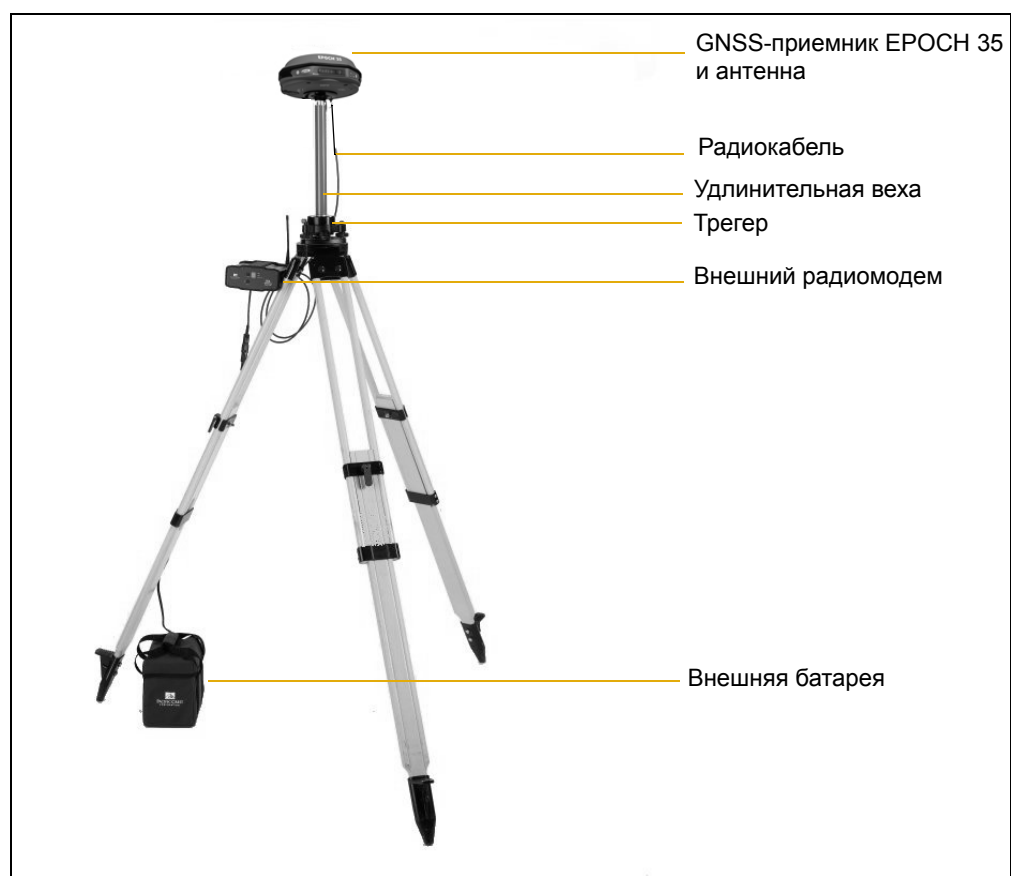
Рисунок 2.3 GNSS-приемник EPOCH 35, установка базы
