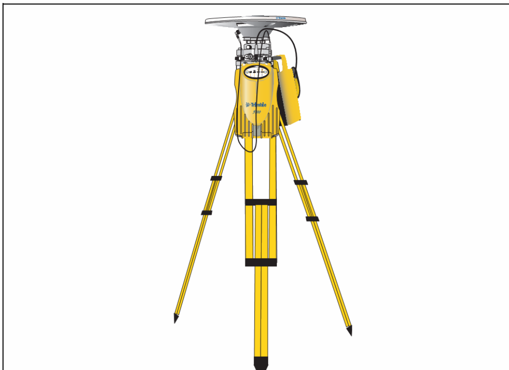
Рис. 3.6 Подготовка приемника для съёмки с камеральной обработкой
