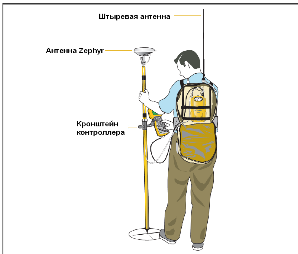
Рис. 3.10 Приёмник, размещённый в рюкзаке
