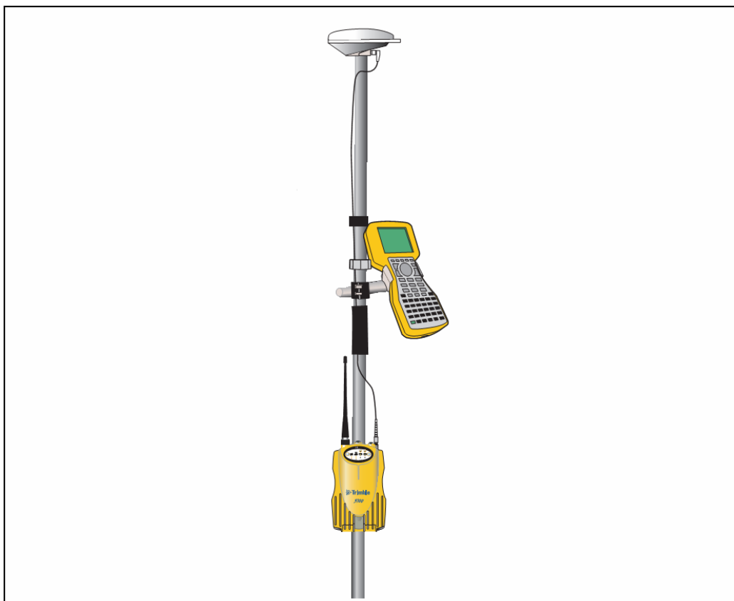
Рис. 3.9 Приёмник, закреплённый на вехе
