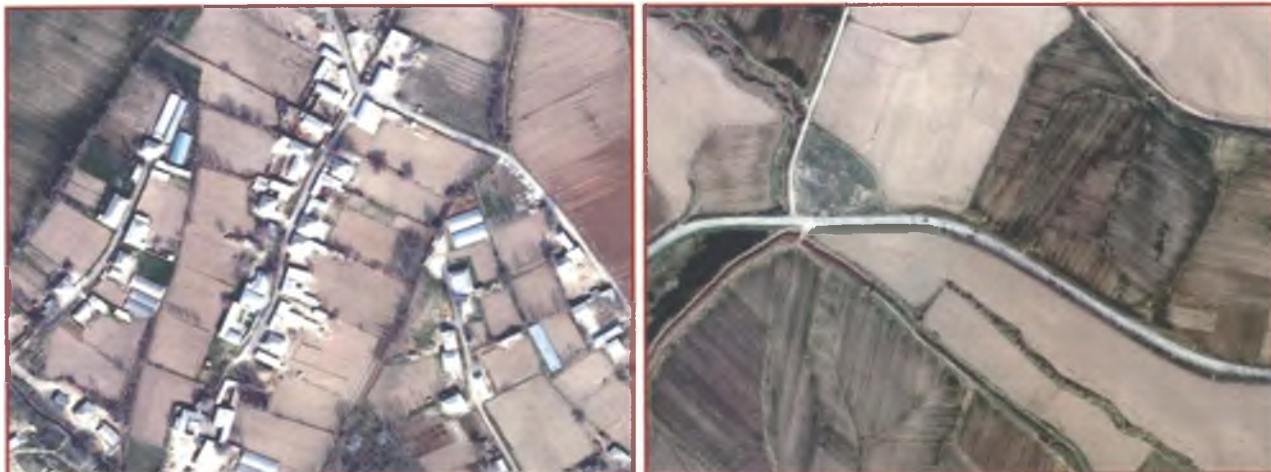
3.1.1 расм. Аэросуратлардан фойдаланиб яратилган 1:10 000 масштабда рақамли ортофотопланлар.
