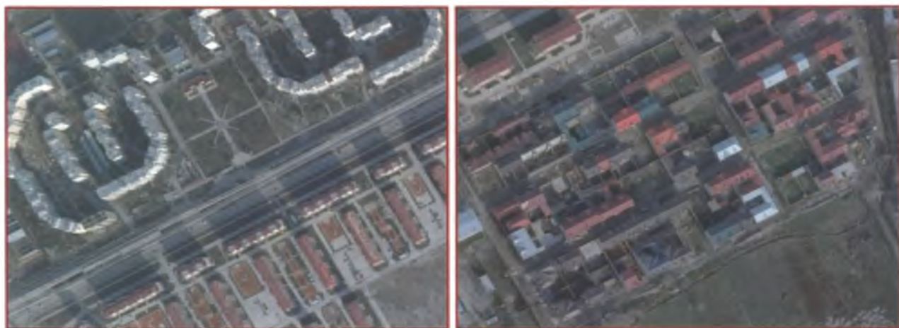
3.1.2 расм. Аэросуратлардан фойдаланиб яратилган 1:2 000 масштабда шаҳарнинг рақамли ортофотопланлар.
