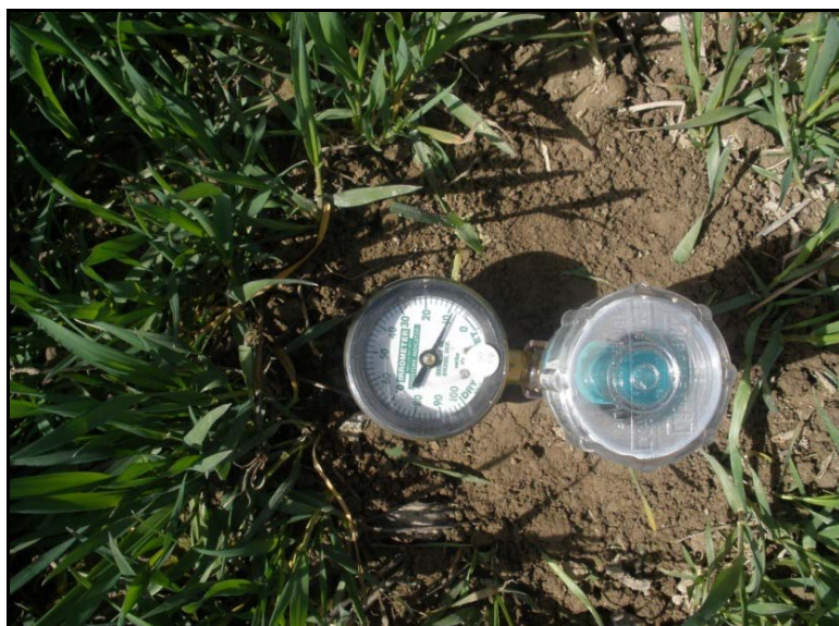
37-rasm. Tenziometrlar yordamida tuproqning namligini aniklab qishloq xo‘jalik ekinlarining sug‘orish muddatlarini aniklash
