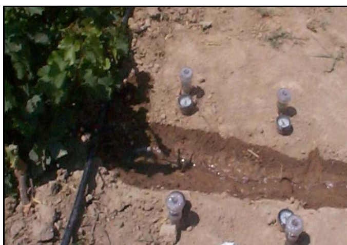
38-rasm. Tenziometrlarni ko‘llaganda sug‘orish suvi 5-15% iktisod kilinadi va qishloq xo‘jalik ekinlarini xosildorligi 8-10% oshadi
