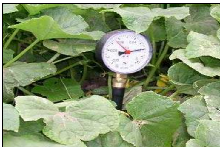
37-rasm. Tenziometrlar yordamida tuproqning namligini aniklab qishloq xo‘jalik ekinlarining sug‘orish muddatlarini aniklash
