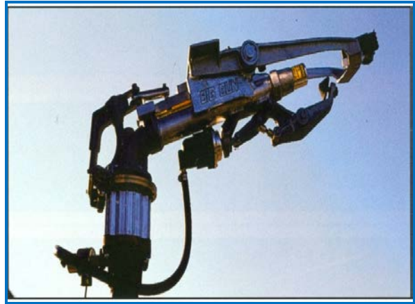
68-rasm. Yomg'irlatish uchliklari: O'rtacha otar yomg'irlatgich apparati a-to'siqli; b,v-oqimli
