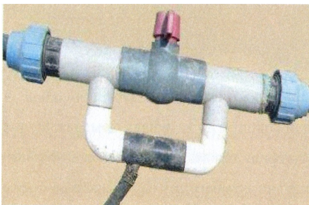
103-rasm. Tomchilatib sugʻorish tizimi tarkibidagi oʻgʻit etkazib byeruvchi “Venturi”injektori
