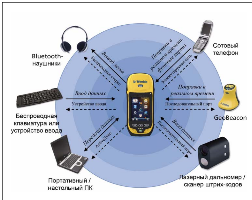
Рисунок 6.1. Подключения контроллера серии GeoExplorer 6000 в качестве Bluetooth-клиента
