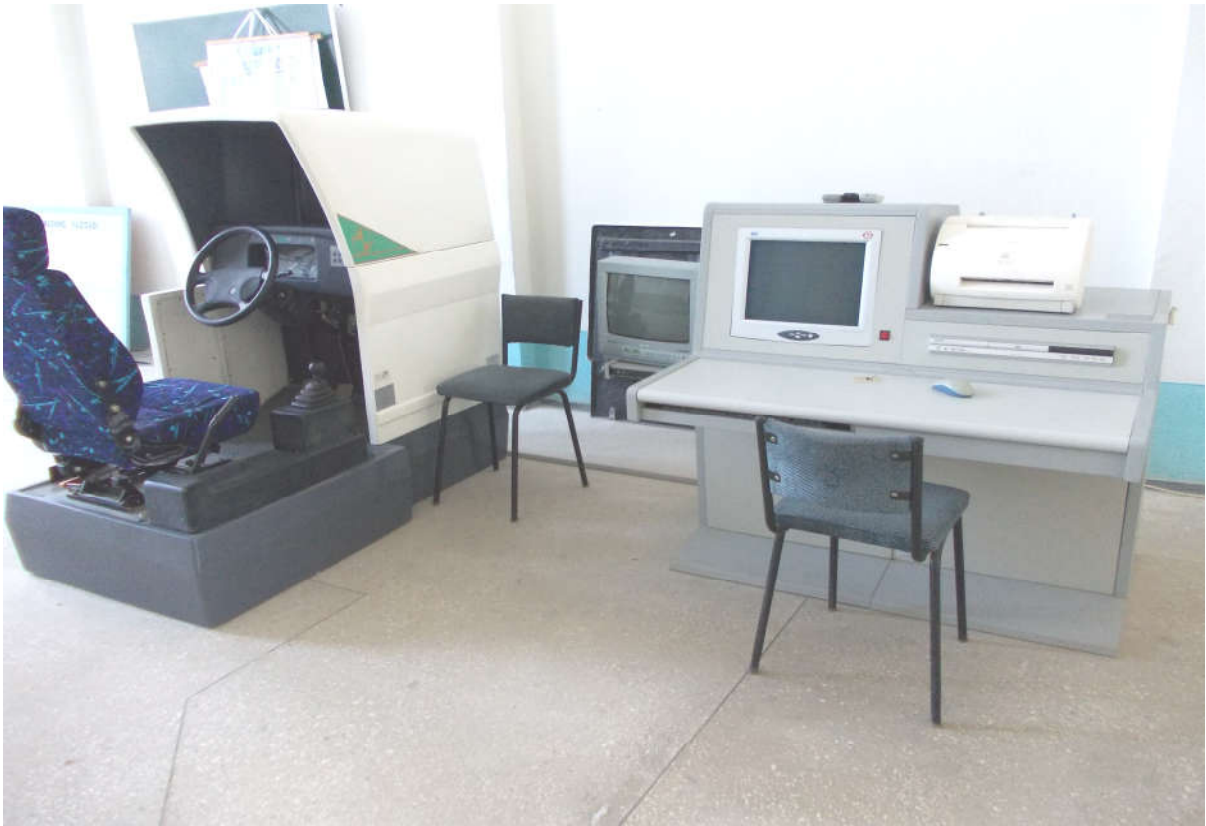
Автомобиль ҳайдовчисининг машқ қилиш аппарати мажмуи
