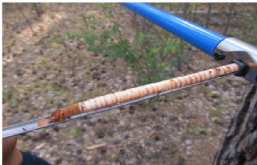
12-Rasm. Perseler burg'ilash uskunasi yordamida olingan yog'och silindrlar
