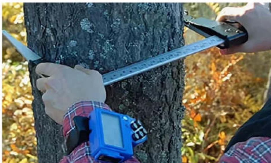
8-Rasm. O'sayotgan daraxtlarning diametrini elektrton o'lchov sanchqisi bilan o'lchash jarayoni
