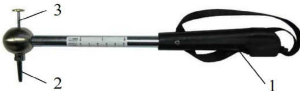
13-Rasm. Daraxtni o'sishini aniqlovchi maxsus bolg'acha: (1-Dastak, 2-bolg'aning uchligi, 3-ekstraktor)
