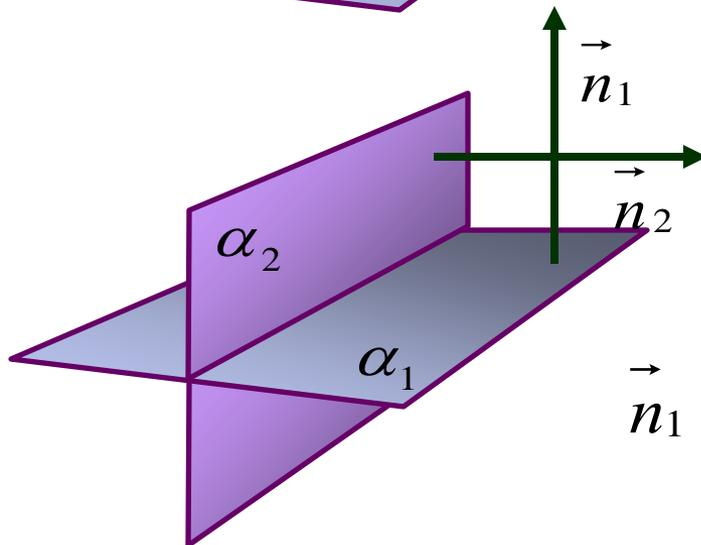
$$\vec{n}_1 \perp \vec{n}_2 \Rightarrow a_1 \cdot a_2 + b_1 \cdot b_2 + c_1 \cdot c_2 = 0$$
