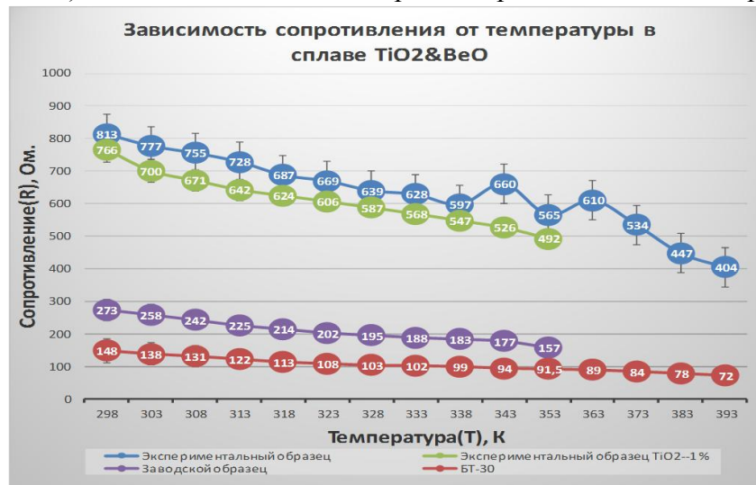
Рисунок 1)б. Зависимость электросопротивления от температуры бериллиевой керамики, полученной в различных технологических условиях.
