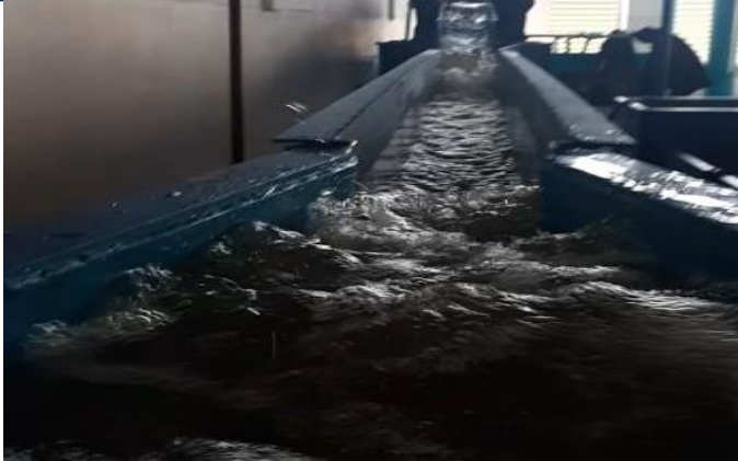
Рис. 2. Модель водобойного колодца с прямоосным отводом потока
