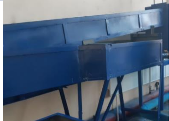
Рис. 3. Модель водобойного колодца с боковым отводом потока
