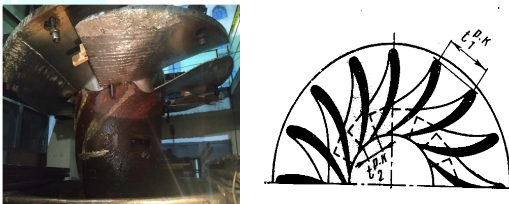
Рис.3 – Контроль установки лопастей рабочего колеса
