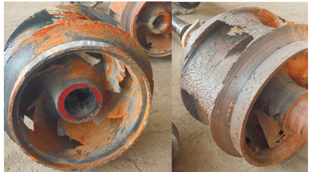
1-расм. Кавитацион емирилиш ва гидроабразив ейилиш таъсирида ишдан чиққан марказдан қочма насос ишчи ғилдираклари
