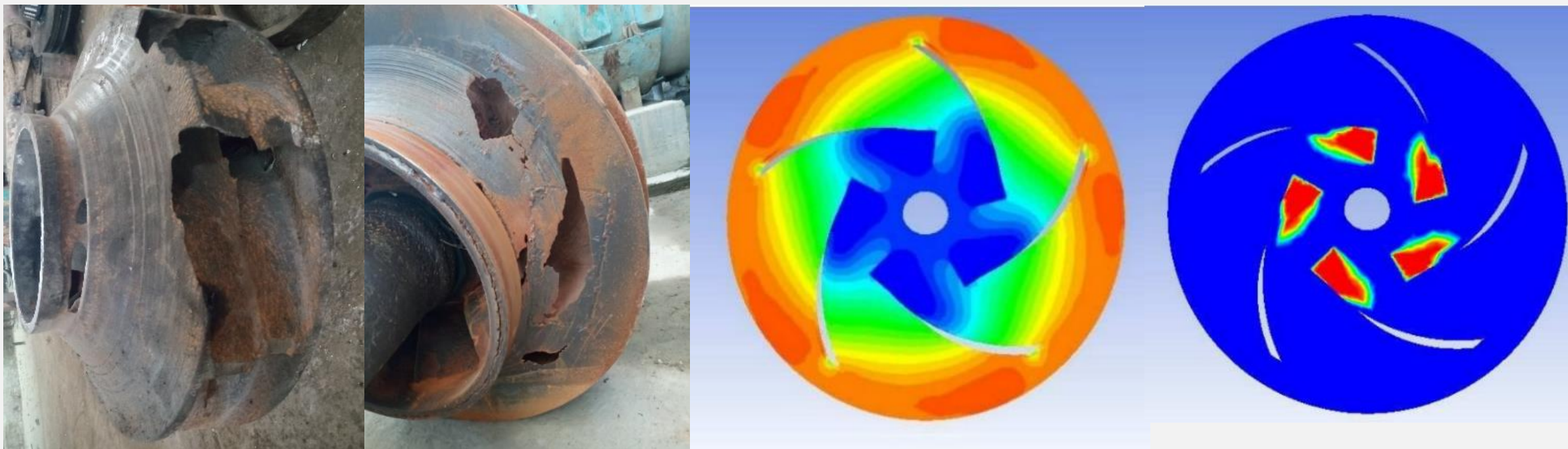
1-расм. “Д” турдаги насос ишчи ғилдиракларини кавитация натижасида емирилиши
