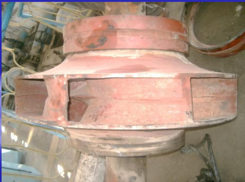
4-расм. «Д» турдаги насос иш ғилдирагининг абразив емирилиши: а-ишга туширишдан олдинги ҳолати; б-вегетация давридан сунгги ҳолати.
