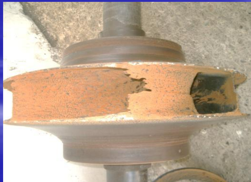
4-расм. «Д» турдаги насос иш ғилдирагининг абразив емирилиши: а-ишга туширишдан олдинги ҳолати; б-вегетация давридан сунгги ҳолати.
