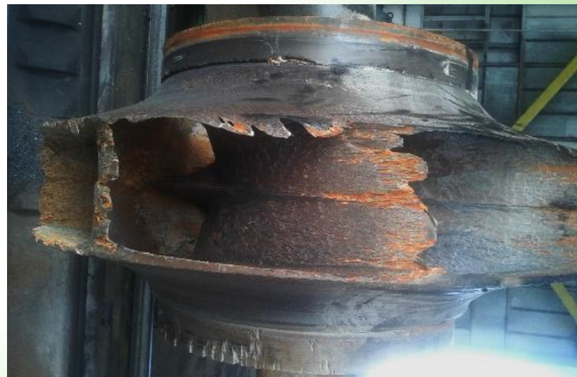
1- расм. “Д” турдаги насос иш ғилдиракларининг абразив емирилиши.
