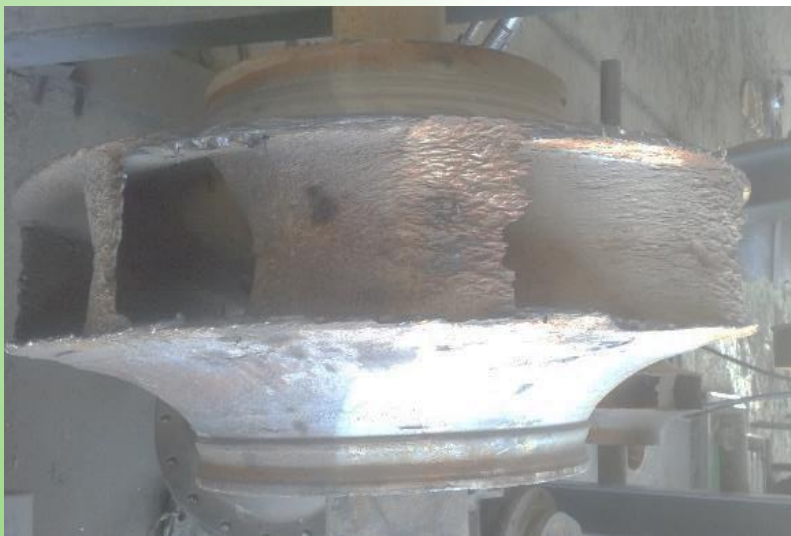
1- расм. “Д” турдаги насос иш ғилдиракларининг абразив емирилиши.
