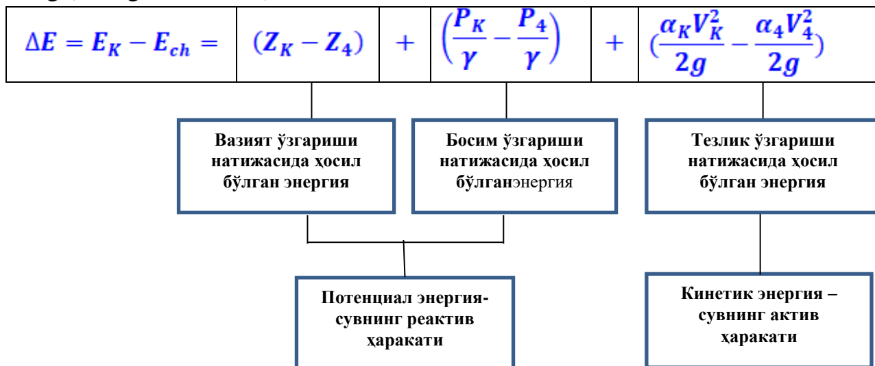
8.11-rasm. 1-tenglama-sxema. Potensial va kinetik energiyaning tashkil qiluvchilari.
