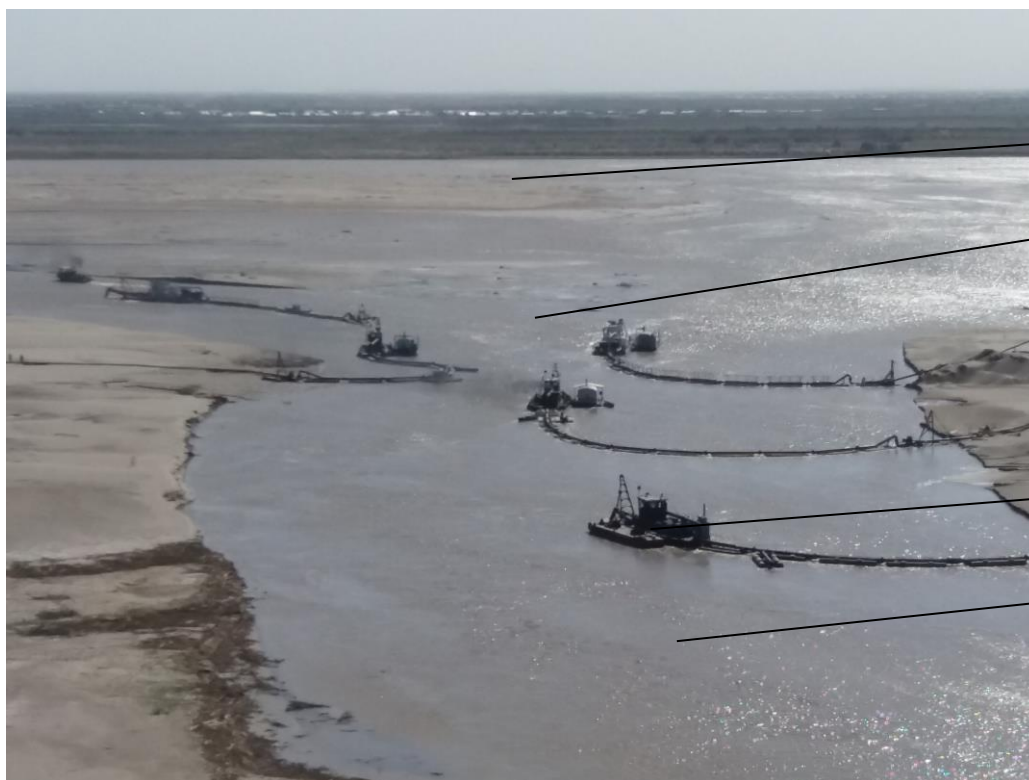
1-Amudaryo; 2-to‘g‘onsiz suv olish inshooti; 3-zemsnaryad (loyqa tozalash mashinasi); 4- nasos stansiyasiga suv olish kanali.
