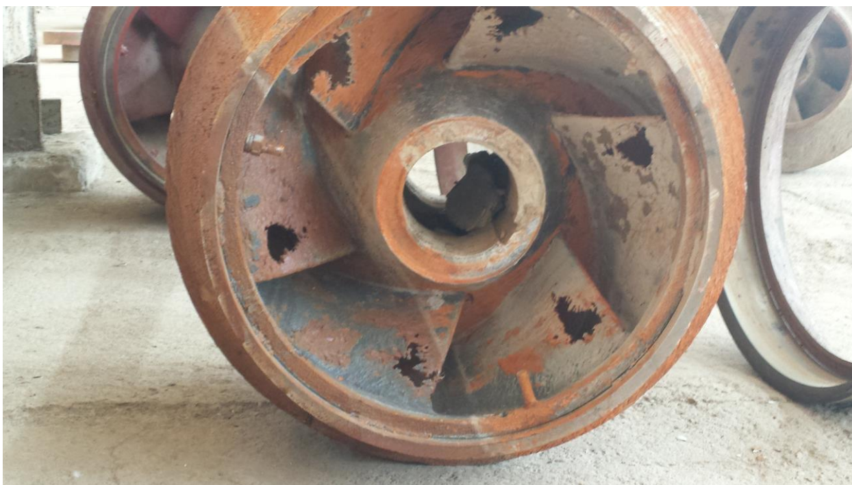
8.3 rasm-Ishchi parrakka suv kirish joyida sodir bo‘lgan kavitatsiya jarayoni.
