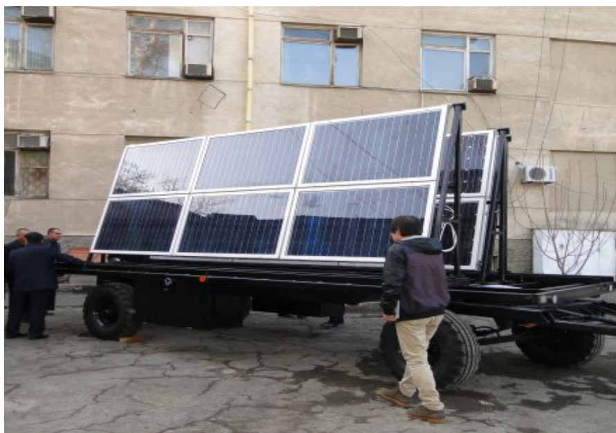
Рис.2. Мобильная фотоэлектростанция мощности 3 кВт для сельского хозяйства.
