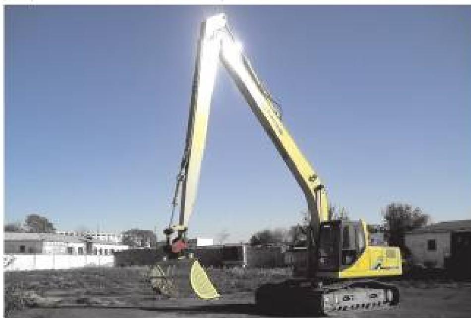
**Рис.1. Ковш-косилка на базе одноковшового гидравлического экскаватора[6].**
