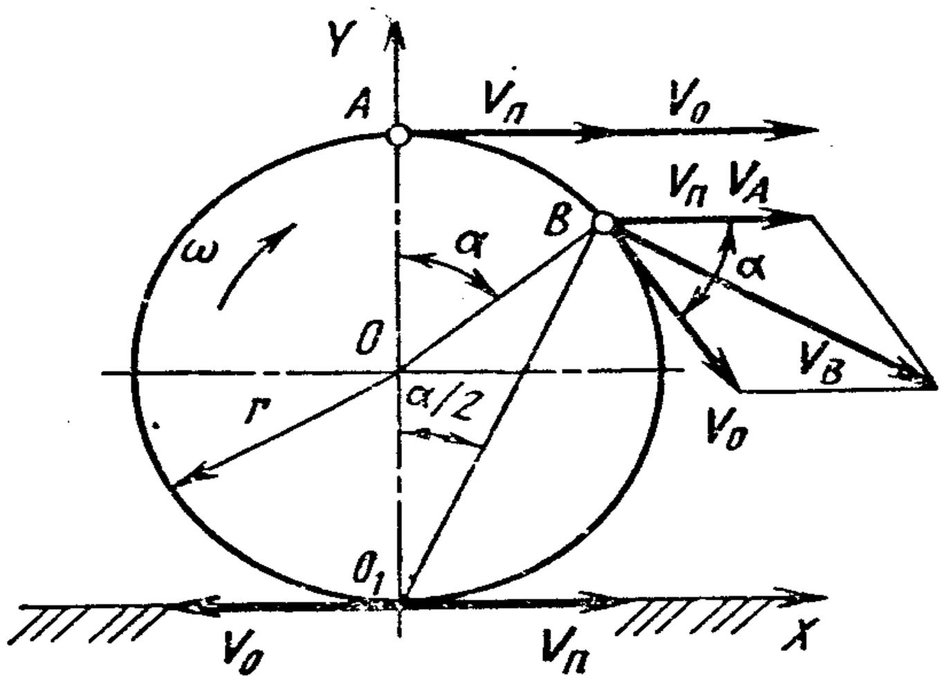
$O$  –ғилдиракни геометрик ўқи;  $O_1$  –оний айланиш ўқи;  $\omega$  -бурчак тезлиги;  $r$  - ғилдирак тўғинининг радиуси;  $v_{\text{н}}$  –ғилдирак тўғинини кўчирма – илгарилама тезлик харакатининг вектори;  $v_0$  – нисбий харакатнинг тезлик вектори;  $v_A$  –  $A$  нуктадаги йиғинди тезлик вектори;  $v_B$  –  $B$  нуктадаги йиғинди тезлик вектори.
