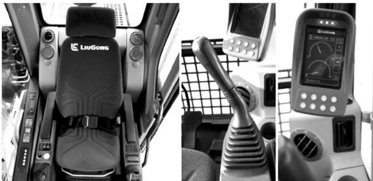
Рис 9.7. Кресло оператора и система управления экскаватора.
