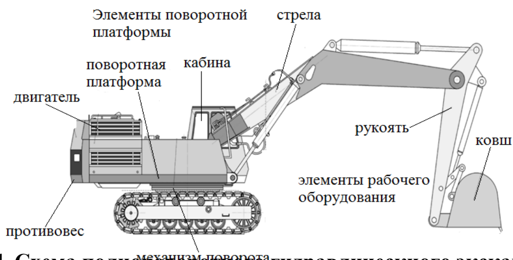
Рис 9.4. Схема полноповоротного гидравлического экскаватора с рабочим оборудованием обратная лопата.
