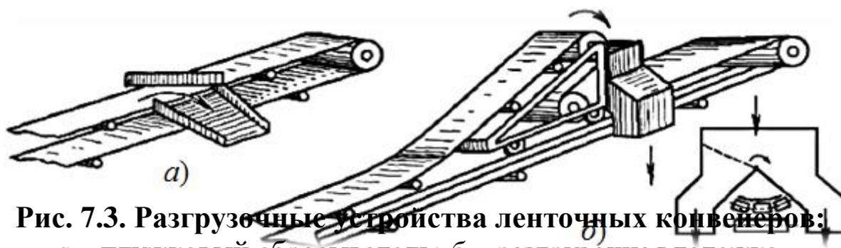
Рис. 7.3. Разгрузочные устройства ленточных конвейеров:
