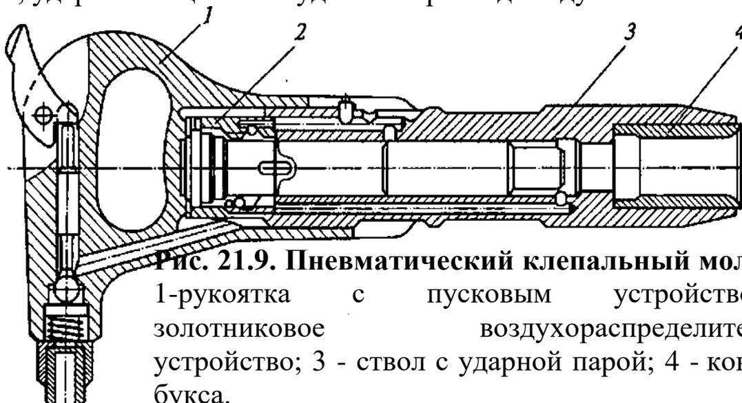
**Рис. 21.9. Пневматический клепальный молоток:**
