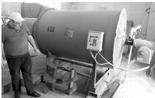
1-расм. ТГУ русумли иссиқлик генератори ва унинг ёниш камерасига ўрнатиладиган винтли мосламаларнинг кўриниши
