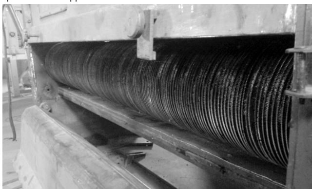
1-расм. Комбинацияланган арра-металл чўткали цилиндрнинг Чуст пахта тозалаш корхонаси қошидаги уруғлик чигит тайёрлаш цехидаги УЧДМ машинасига ўрнатилишининг умумий кўриниши.
