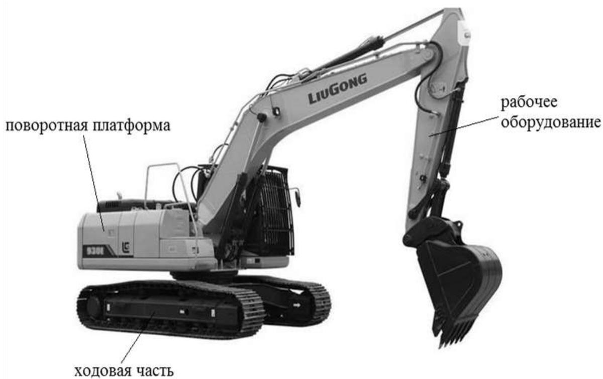
Рис.9.5. Общий вид экскаватора Liugong CLG 925D.
