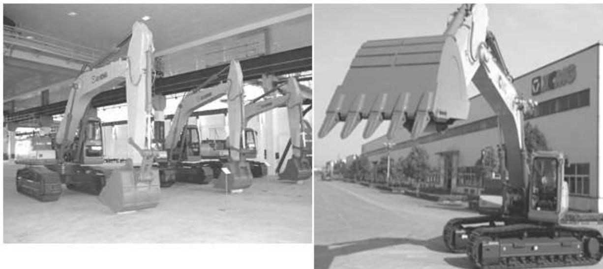
**Рис 9.10. Одноковшовые гидравлические экскаваторы с рабочим оборудованием обратная лопата выпускаемых СП UzXCMG.**
