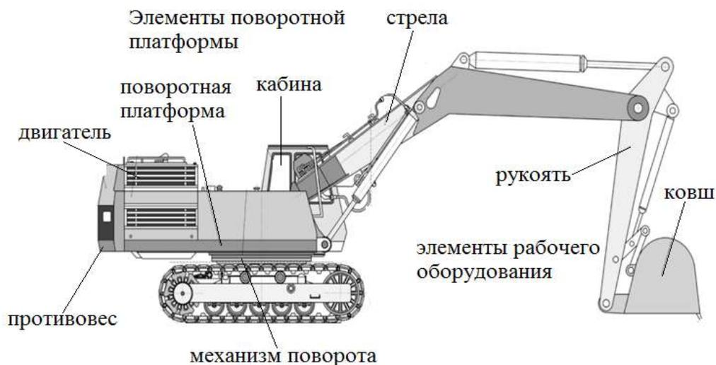
Рис 9.4. Схема полноповоротного гидравлического экскаватора с рабочим оборудованием обратная лопата.
