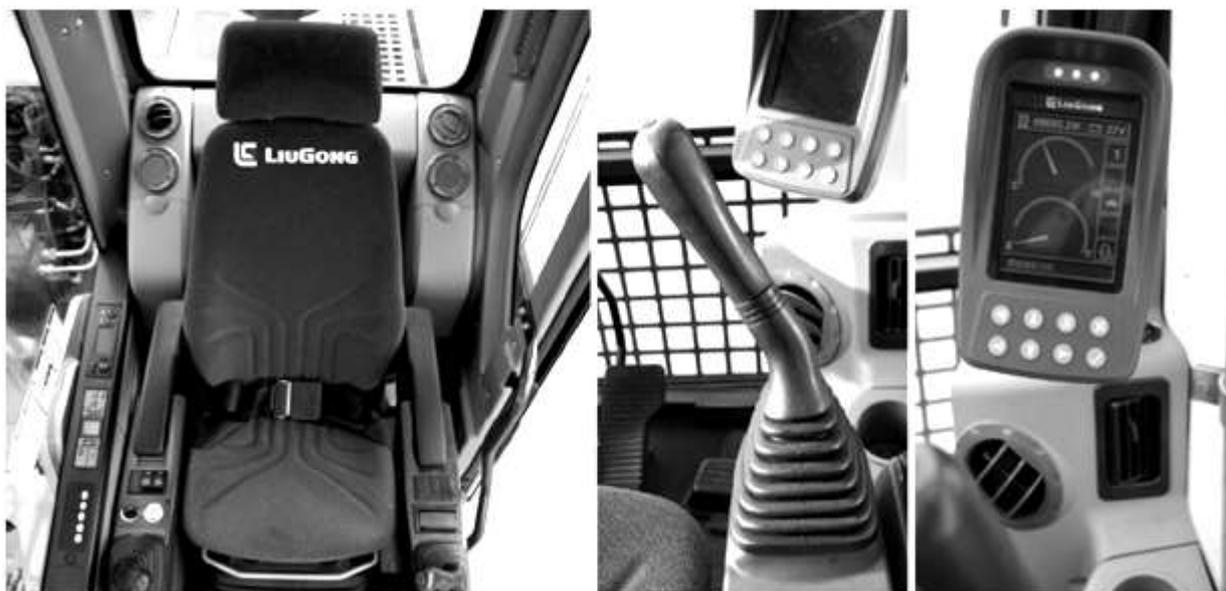
**Рис 9.7. Кресло оператора и система управления экскаватора.**
