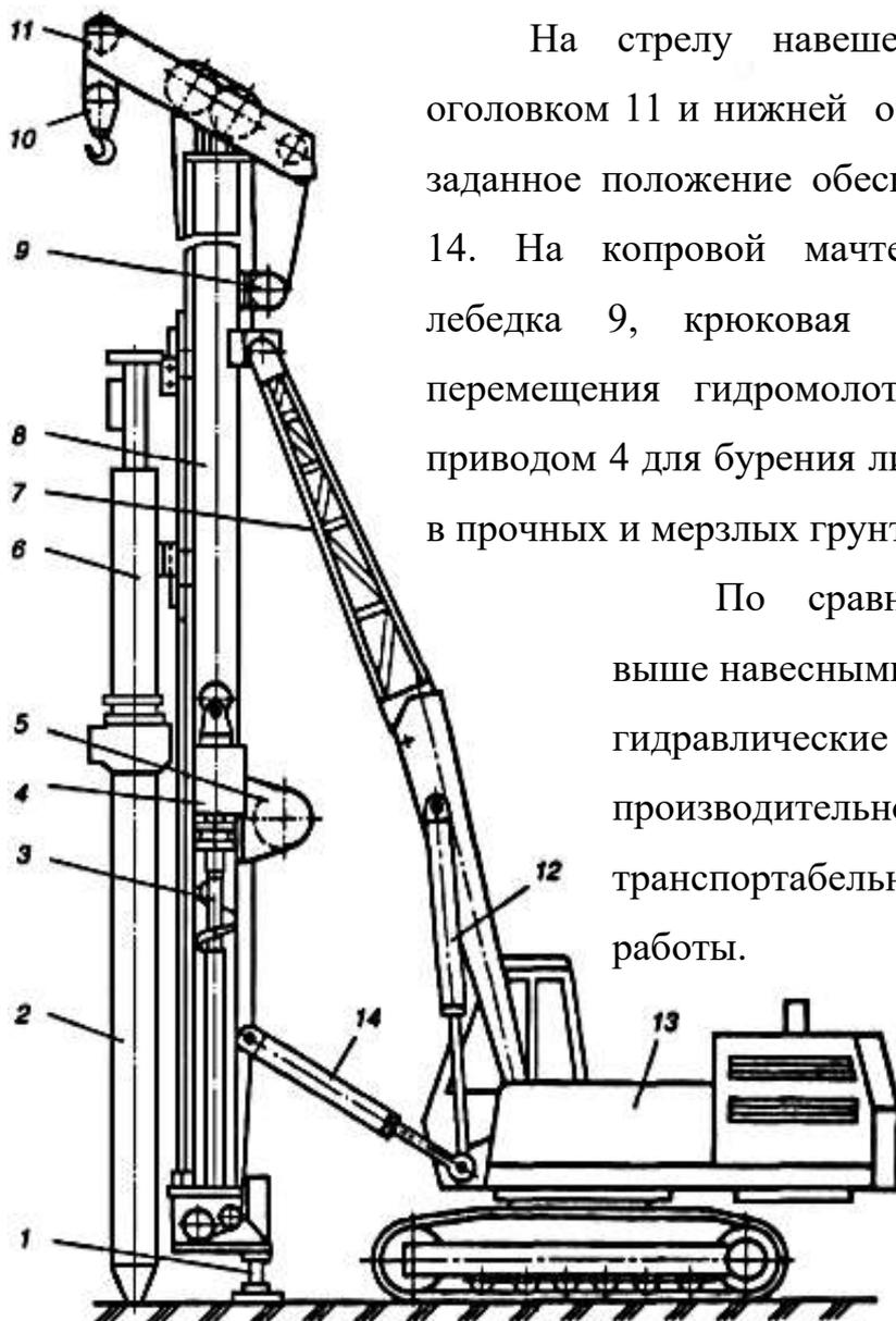
На стрелу навешена копровая мачта 8 с оголовком 11 и нижней опорой 1. Установка мачты в заданное положение обеспечивается гидроцилиндром 14. На копровой мачте смонтированы: грузовая лебедка 9, крюковая подвеска 10, лебедка 5 перемещения гидромолота 6, шнековый бур 3 с приводом 4 для бурения лидерных скважин под сваи 2 в прочных и мерзлых грунтах.
