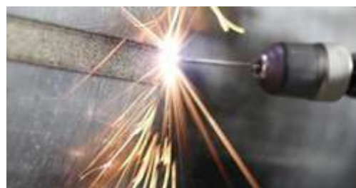
3-расм. Махсус тайёрланган намунага қоплама қоплаш жараёни.
