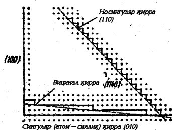
II.12-расм. Содда кубик панжарада турлича йўналган бурчак сиртларининг тузилиши.
