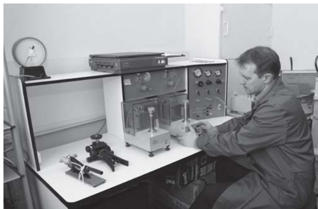
Первичный осмотр задатчиков давления Воздух-1600 1992 г.в., производства ВНИИМС, г.Москва.
