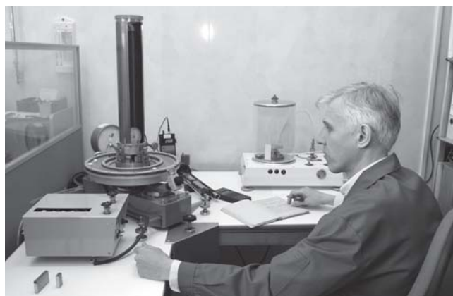
Снятие метрологических характеристик задатчиков давления «Воздух-250» 1990 г.в., производства завода Эталон, г.Киев
