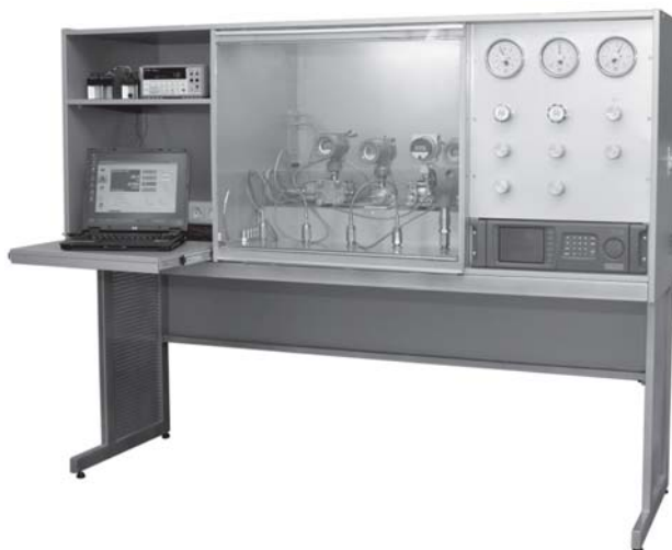
Рис. 1. Внешний вид метрологического стенда с автоматическим заданием давления (изготовлен по заказу ФГУП «РОСТЕСТ-Москва», приведен в качестве примера).
