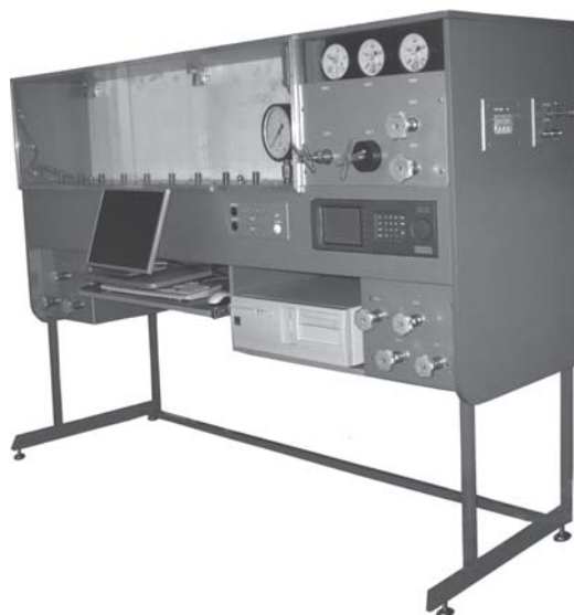
Рис. 1. Внешний вид метрологического стенда с автоматическим заданием давления, (изготовлен по заказу предприятия «Сатка», г.Магнезит, приведен в качестве примера).
