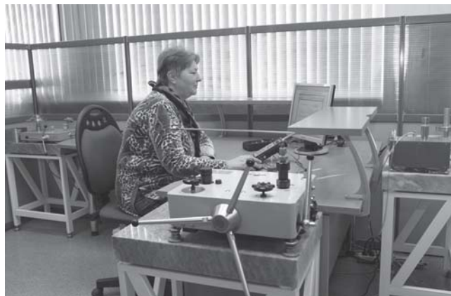
Представитель Челябинского ЦСМ проводит поверку калибратора давления
