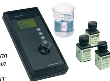
**Рис. 1.7.** Оборудование для периодического измерения и контроля содержания дезинфектантов: Copex DIT
