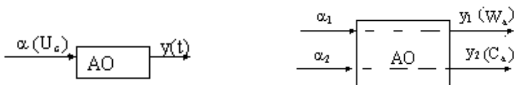
3.2- rasm Bitta kirish va chiqish signaliga ega bo'lgan oddiy avtomatlashtirish ob'ektning tarkibiy ko'rinishi
