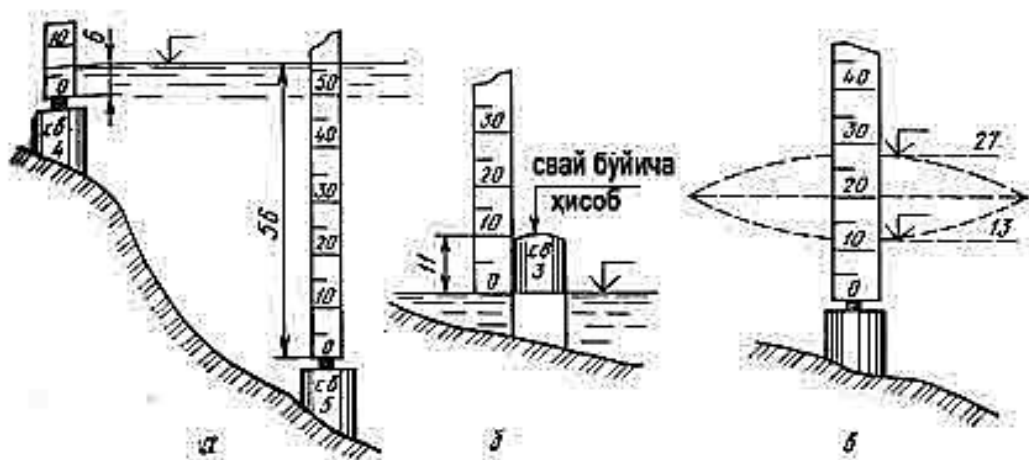
5.1– rasm Suv o'lchash postlarida suv sathini o'lchash variantlari:
