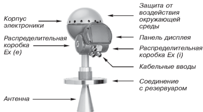
Рис. 1. Конструкция уровнемера.
