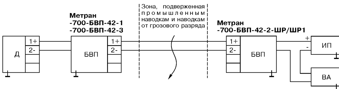
Рис.5. Защита датчика, ИП и ВА при 2-х-проводной линии связи с помощью 2-х барьеров.
