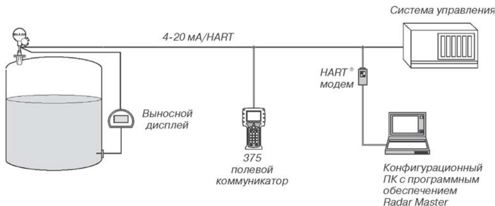
Рис.14. Интегрированная система с использованием HART-коммуникатора.
