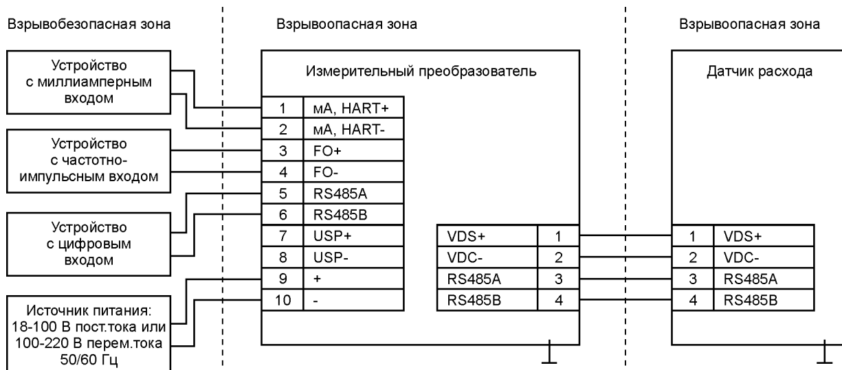
Рис. 14. Удаленный монтаж ИП.
