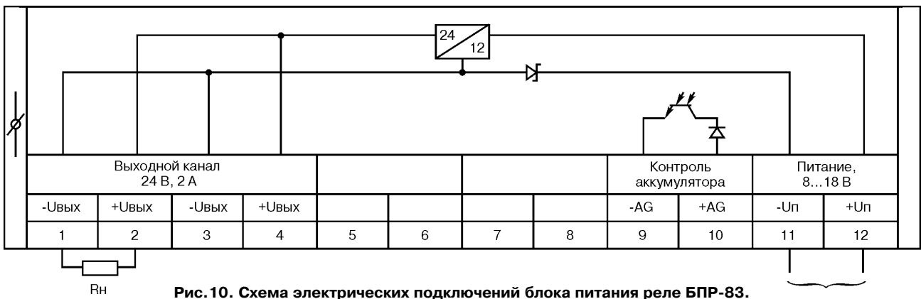
Рис.10. Схема электрических подключений блока питания реле БПР-83.
