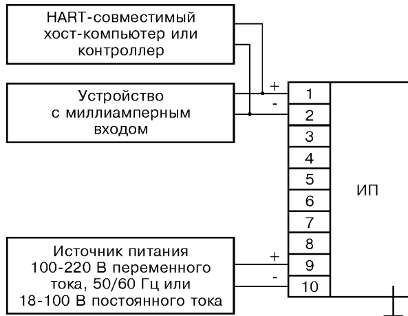
Рис. 11. Подключение одиночного HART-аналогового контура.
