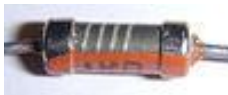
Plyonkali burchak rezistori (tok o‘tkazuvchi yuzasi namoyishi uchun yopilgan himoya qismi olib tashlangan).
