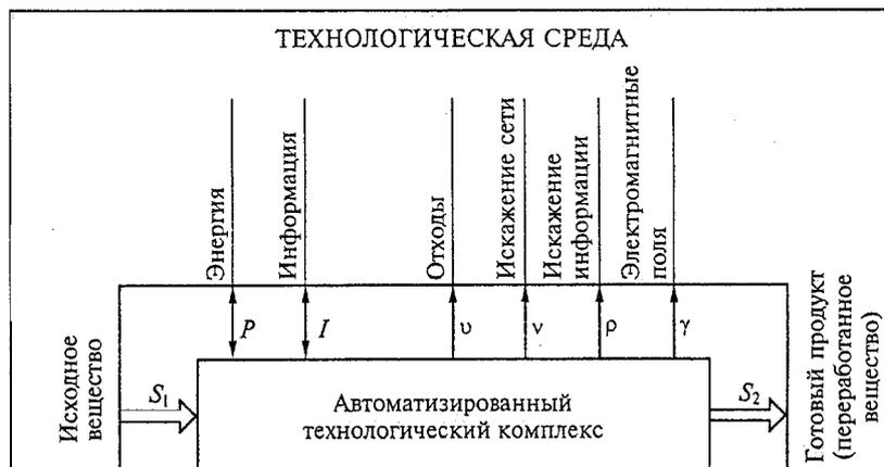
Рис. 1.3. Функциональная схема получения готового продукта
