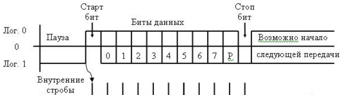
Рис. 8.2. Формат асинхронной передачи
