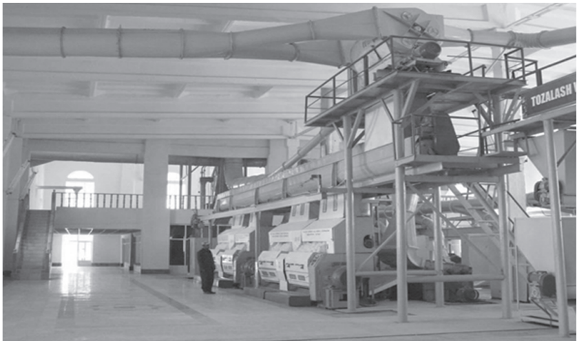
15.7-rasm. Hozirgi kunda paxta sanoatimizda qoʻllanilib kelinayotgan jinlash sexi va DP-130 rusumli arrali jin mashinasining umumiy koʻrinishi.
