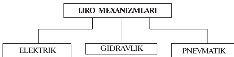
6.1-rasm. Ijro mexanizmlarining energiya turiga qarab turlanishi.
