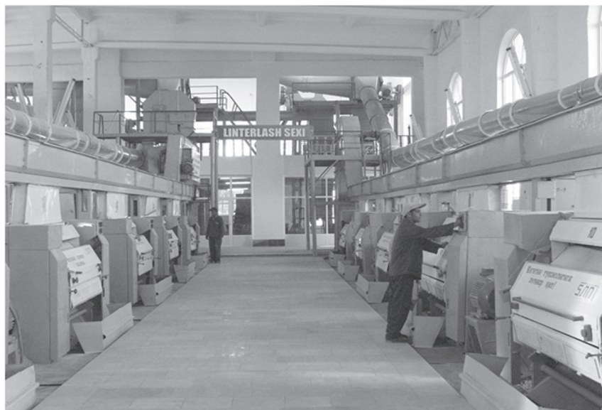
15.8-rasm. Linterlash sexi va 5-LP rusumli arrali linter mashinasining umumiy ko'rinishi.
