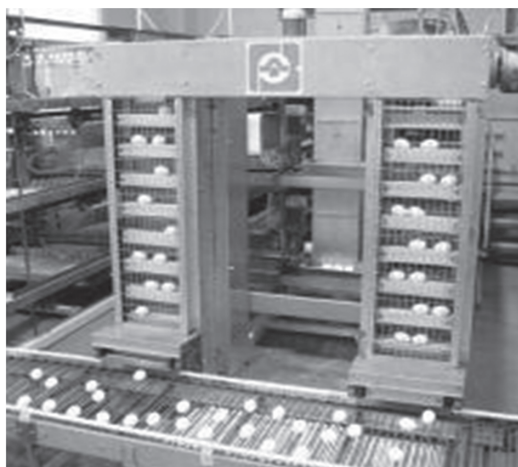
13.8-rasm. Tuxum yig‘ish elevاتورining umumiy ko‘rinishi.
