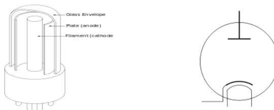
2.10.-rasm. Vakuumli diodning tuzilish sxemasi: shishali lampa markazida qizdiriladigan katod, aylana bo‘yicha esa anod. O‘ng tomonida esa lampali diodning sxemada belgilanishi
