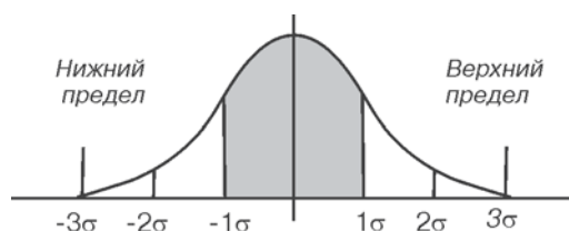
Рис.1. Кривая распределения погрешности для преобразователя модели Rosemount 848T, сконфигурированного с сенсором Pt 100, в диапазоне температур от 0 до 100°С.
