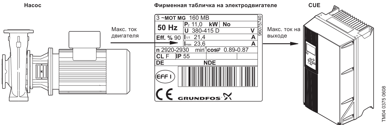
Рис. 45 Подбор CUE на основании максимального тока двигателя.
