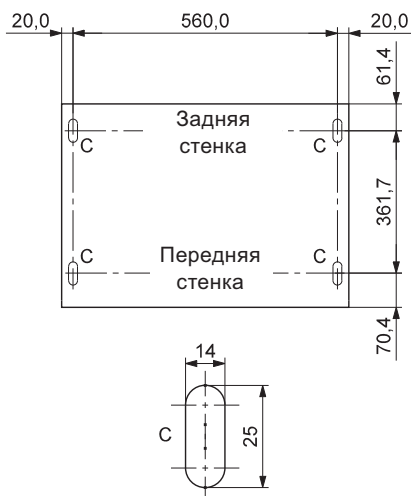
Рис. 56 Шаблон для сверления под подставку (мм)
